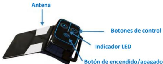
Dispositivo portátil (sin banda de sujeción)
